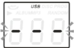
1. Drücken Sie zunächst die Taste CD/USB und anschließend die Taste FUNCTION, um den USB-Modus einzuschalten. „---“ und das USB-Icon erscheinen im Display.
