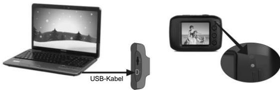
Der Ladevorgang beginnt, wenn die Kamera im ausgeschalteten Zustand mit dem Computer verbunden ist. Während des Ladevorgangs leuchtet der Akkuanzeiger und schaltet sich ab, wenn vollständig geladen wurde. In der Regel ist der Akku nach 2-4 Stunden vollständig aufgeladen.
